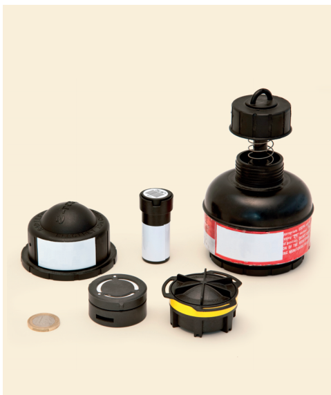
Passive Messgeräte zur Bestimmung der Radonkonzentration
